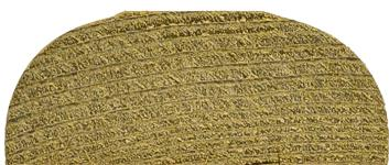
**Latten** 20 x 50 mm - oben abgerundet, mit gefräster Nut, ca. 20 mm breit, 8 mm tief nicht gefast - optimal als obere Abdeckleiste für 20 mm Zaunbretter
